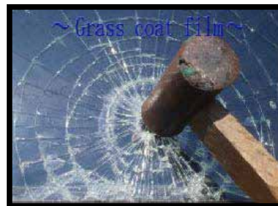
7Hフィルム片面貼3mmガラスハンマーによる飛散実験
