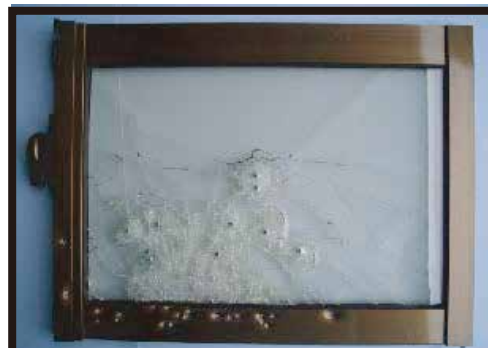
9H4層ダンガードフィルム片面貼 3mmガラス散弾銃実射試験
