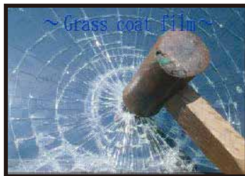
7Hダンガード片面貼3mmガラス ハンマーによる強度実験
